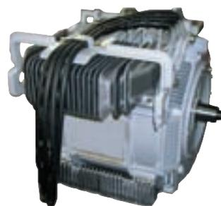
全閉方式主電動機
